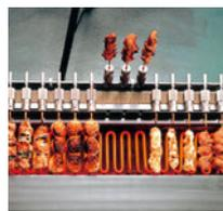
ベルトの回転で串がクルクル回り、自動的に焼け、人手いらずで、タレもよくからみます。
